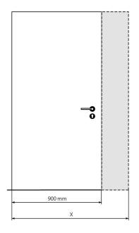
Nella scelta e determinazione di una cerniera, la portata viene spesso messa sullo stesso piano del peso della porta. Il carico sulla cerniera può però spesso essere molto superiore al peso della porta a causa di diversi fattori.
