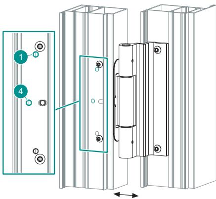
**□ Andruckverstellung / Depth adjustment /
